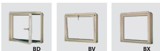
Das Kniestockfenster **BD\_** ist ein Dreh-Kipp Fenster, bei dem der Fensterflügel um 11cm gekippt und um 90° gedreht werden kann. Der Griff dafür befindet sich am seitlichen Fensterflügelteil. Die Fenster können mit Anschlag rechts (BDR) oder links (BDL) bestellt werden. Das Kniestockfenster **BV\_** sind Fenster mit Kippflügel, die um 11 cm gekippt werden können. Der Griff befindet sich im oberen Flügelteil. Das Kniestockfenster **BX\_** ist ein Fixelement.
