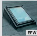
**EFW** - Das Flach-Dach-System ermöglicht den Einbau von FAKRO Dachflächenfenstern auch bei sehr geringen Dachneigungen, da der Neigungswinkel zwischen Fenster und Dachfläche um 15 Grad erhöht wird. In diesem System können sowohl feststehende als auch öffnungsfähige Fenster eingebaut werden.
